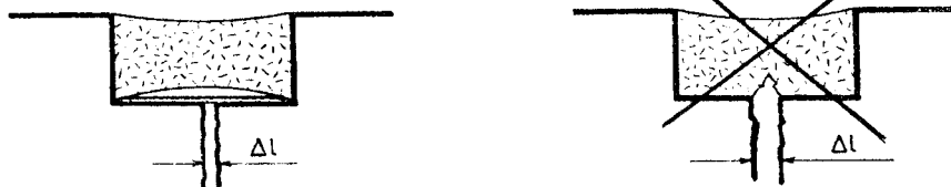
② Etat après ouverture de la fissure vivante
