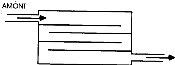
Figure 14 RACCORDEMENT SUR BASSIN A SERPENTIN
