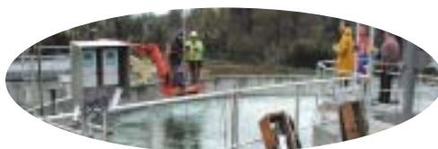
Le protocole détaillé figure notamment dans Duchène *et al.*, 1995. Il est rapide mais nécessite un calibrage précis, sondes en place, des capteurs oxymétriques. Il est préconisé par le CCTG fasc. 81 Titre II (en fin de refonte, publication prévue au second semestre 2002)
