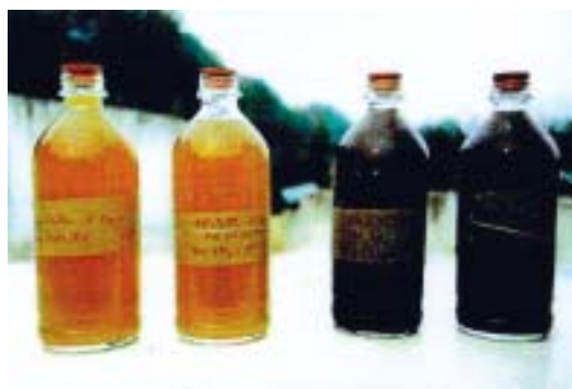
Photo 3 – Aspect visuel comparatif du filtrat primaire et des matières de vidange brutes
