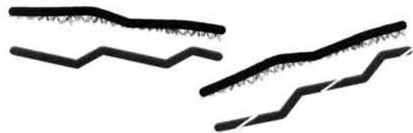
fig. IV-2 Poches de transport, poches de remontées
