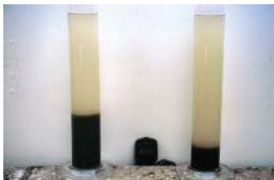
Figure 16 – Test en éprouvettes après 30 mn – eau interstitielle chargée
