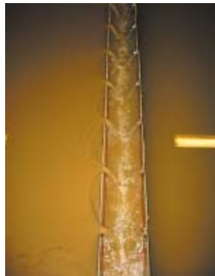
Figure 13– Goulotte de sortie commune à deux files avec perte de boue à gauche
